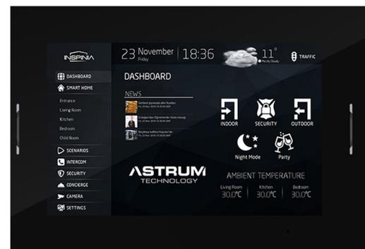
● تاج پنل شیشه ای با صفحه نمایش لمسی خازنی ۴ و ۸ و ۱۰ اینچ دارای سیستم عامل اندروید-استاندارد KNX
